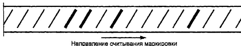
Рисунок 2 — Пример прокатной маркировки предприятия-изготовителя под номером 14
